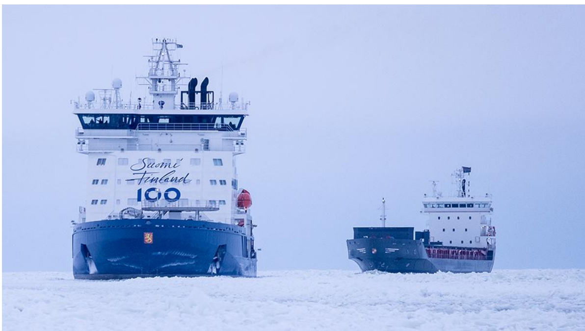
Polaris, världens första isbrytare som kan drivas med både diesel och flytande naturgas (LNG). Bild: Timothy Bird
